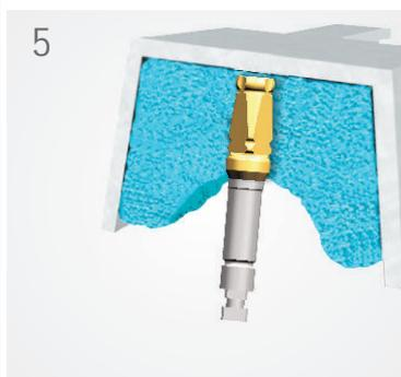
5 Svitare il Mounter dall'implanto. Lavare e controllare l'impronta. Inserire l'insieme del Mounter – Analogo nell'impronta.
